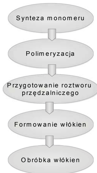
Rys. 2.3. Schemat wytwarzania włókien syntetycznych
