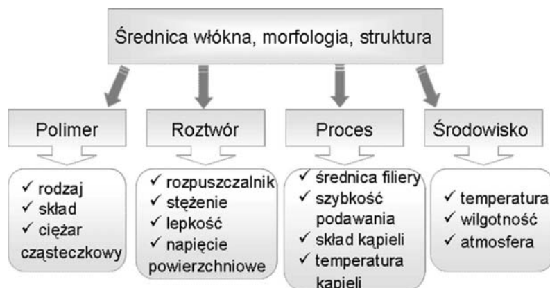
Rys. 2.10. Parametry wpływające na średnicę, morfologię i strukturę włókien
