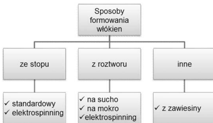
Rys. 2.4. Metody formowania włókien chemicznych
