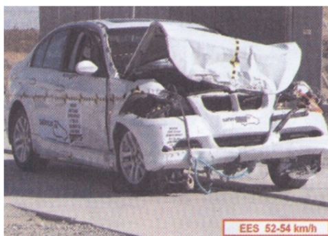
Rys. 1.1. Przykład katalogu zdjęć zdeformowanych pojazdów testowych wykorzystywanych do metody porównawczej [34], [35]
